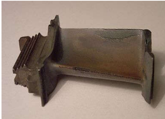
شکل ۱-۱: پره توربین سالم و پره توربین آسیب دیده تحت اثر خزش [۱]
