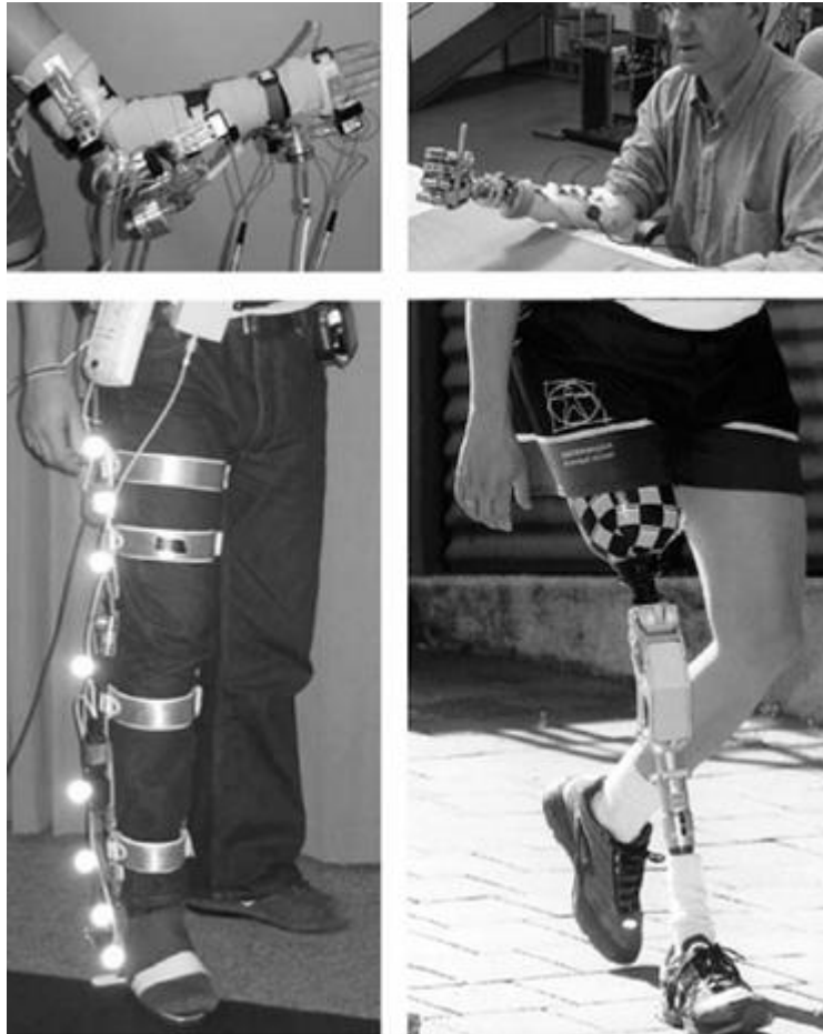
شکل ۱-۱. ربات‌های پوششی (بالا سمت چپ) یک ربات اگزواسکلتون بالاتنه ۱ ، (بالا سمت راست) یک ربات (پایین سمت چپ) یک ربات اگزواسکلتون پایین‌تنه ۲ ، (پایین سمت راست) یک ربات پروستوتیک بالاتنه ۳ ، پروستوتیک پایین‌تنه ۴ . [۵]
