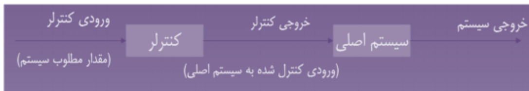
شکل (۲-۱) کنترل حلقه باز
